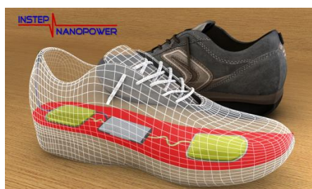
Obr. 9 Bota se zdrojem energie typu Energy harvesting [14]
