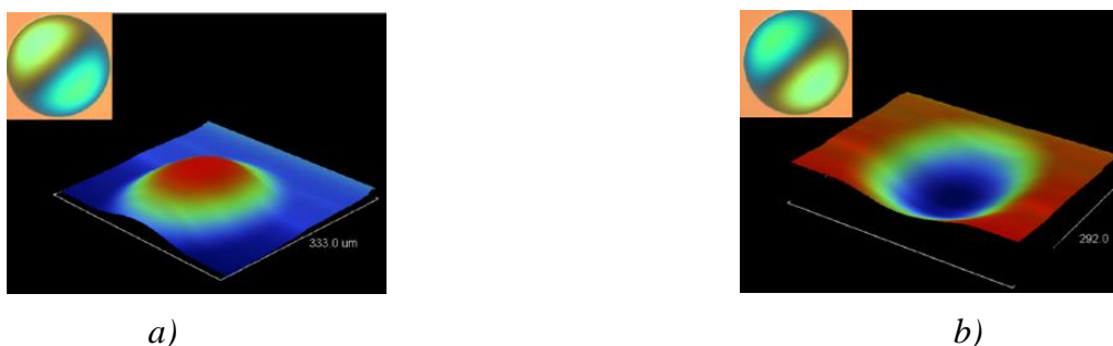
Obr. 22 Model bistabilní MEMS membrány s průměrem 300 µm ve dvou krajních stavech prohnutí [25]
