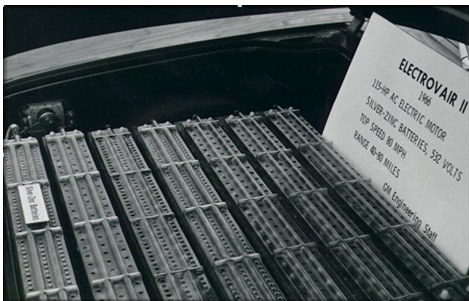
Obr. 4 Stříbro zinková baterie z USA elektromobilu z roku 1966
