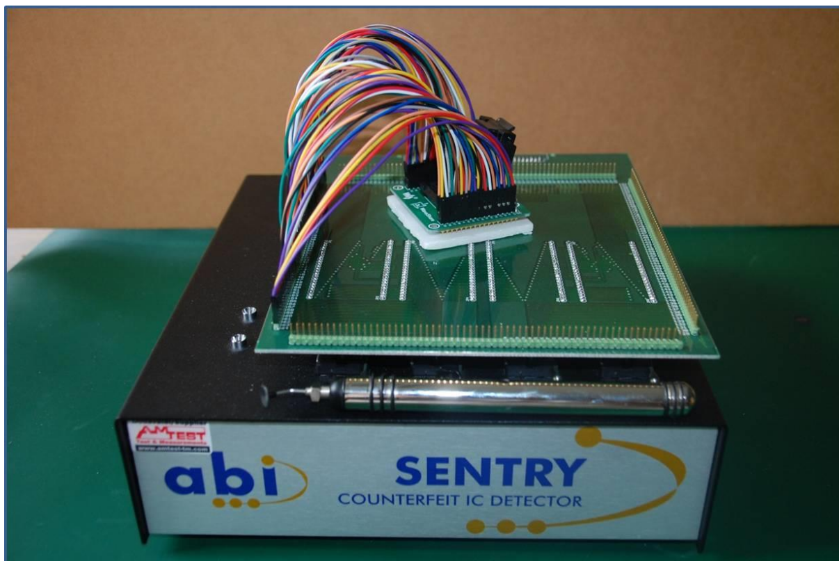
Obr. 16. 256 kanálový přístroj pro komparační analýzu integrovaných obvodů s univerzálním kontaktním adaptérem.
