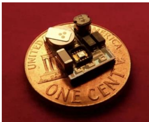
Obr. 25 Kompletní piezoelektrický generátor typu EH realizovaný objemovým mikroobráběním piezoelektrického materiálu [28]
