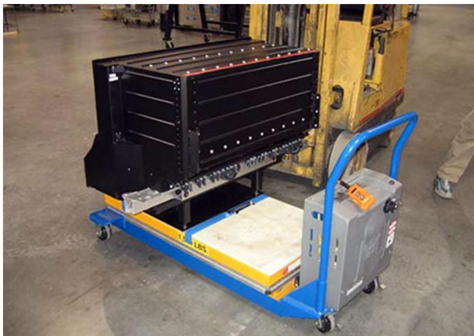
Obr. 1 Baterie 56 kWh pro elektromobil Tesla
