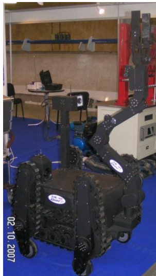
Obr. 8: Vícefunkční průzkumný mobilní robotický systém se strukturovaným pohybovým ústrojím HW LIZARD, Čína.
