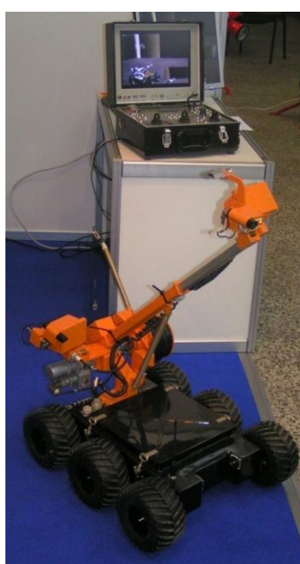
Obr. 5: Vícefunkční mobilní robotický systém určený pro manipulaci s nástražnými systémy.
