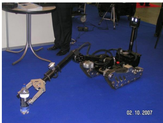
Obr. 9: Vícefunkční mobilní robotický systém určený pro manipulaci s nástražnými systémy, čínské výroby.
