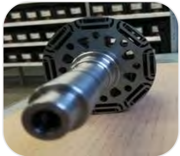
Elektromotory s vysokou hustotou výkonu bez magnetů ze vzácných zemin pro hlavní pohon elektromobilů
