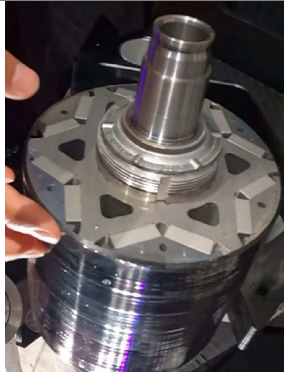
Rotor elektromotoru Tesla model S Plaid s bandáží z uhlíkového vlákna
